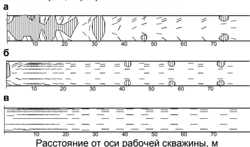
Рис. 1. Ориентация трещин при гидроразрыве в слое каменного угля в массиве пород с боковым распором: 0,5 (а), 0,6 (б), 1 и 1,5 (в)
